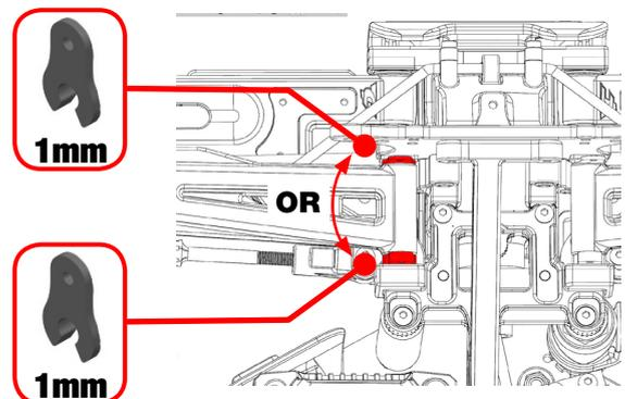
Pour modifier l'angle de chasse, déplacez le bras de suspension supérieur vers l'avant ou vers l'arrière en utilisant les différentes tailles de clips de chasse.
